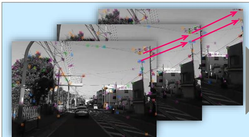
画像上の特徴点を追尾することで、カメラの向き、移動量を逐次算出。カメラ位置を推定
