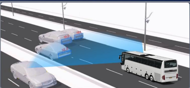
自車車線で前車を検知して、2台の車両の相対速度と相対距離に基づいて衝突時間を判断して、リスクが高い時に警報でお知らせ
