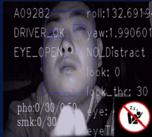
ドライバーの目と口の開閉状況に従って、ドライバーが疲労しているか集中しているかを判断する
