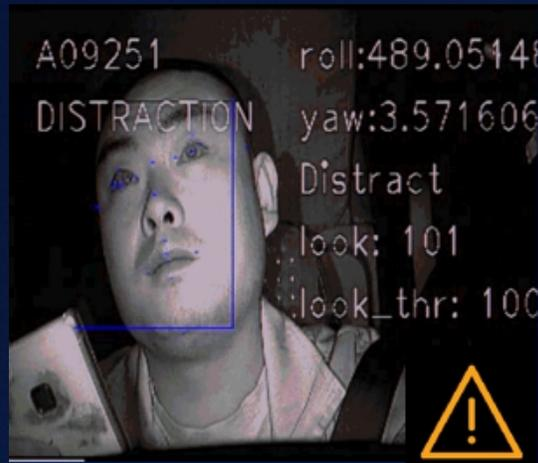
ドライバーの視線方向と車速に基づいて、ドライバーが運転に集中しているかどうかを判断する
