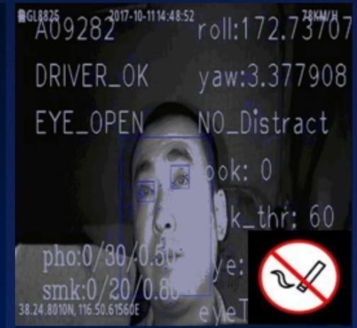
ドライバーの喫煙状況と車速に応じて、運転中に喫煙するかどうかを判断する
